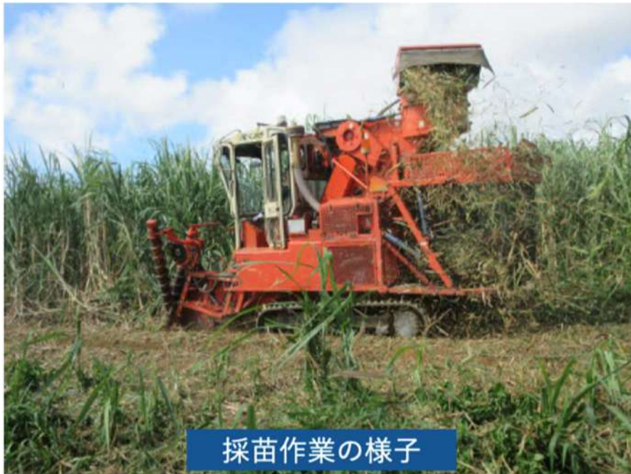
図2 (小型ハーベスタによる苗収穫)
